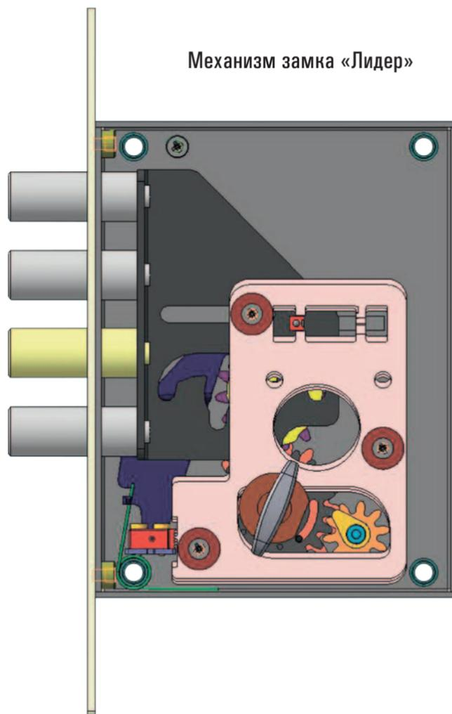
сдвигается к краю кодового паза сувальды. Если сувальды выставлены правильно, то кодовая стойка пройдет в кодовый паз и засов сдвинется в сторону открывания замка на половину своего вылета. Если хотя бы одна сувальда выставлена неправильно — открывания не произойдет. При этом злоумышленник лишен возможности каким-либо образом скорректировать выставление сувальд — из-за их блокировки поменять положение любой сувальды в этой фазе открывания замка невозможно.
